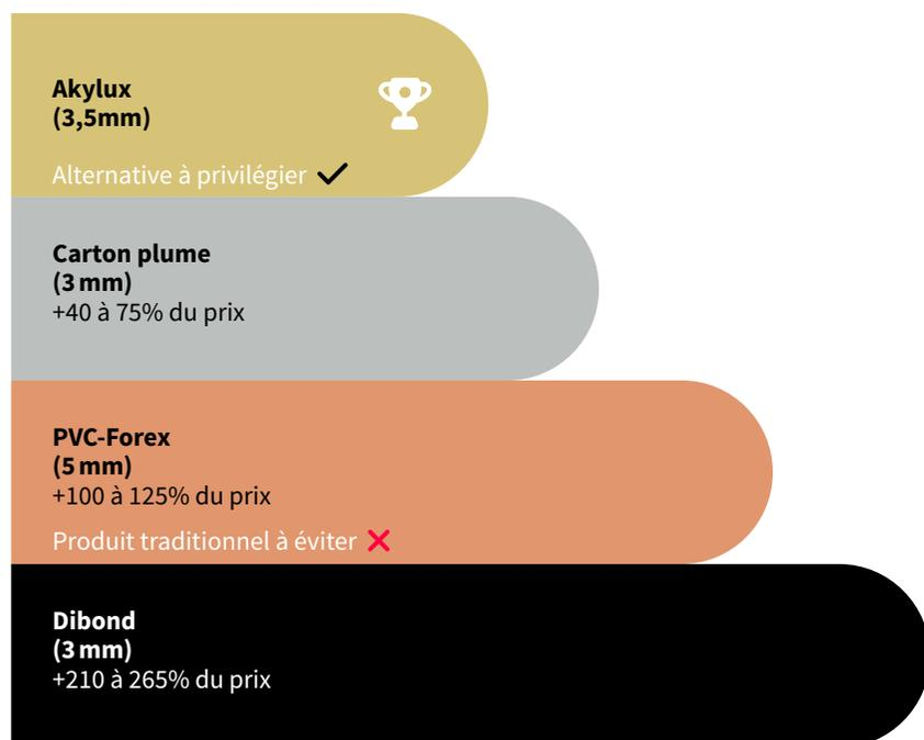
**Figure 9 :** Classement des matériaux au regard de leurs caractéristiques environnementales (panneaux rigides)
